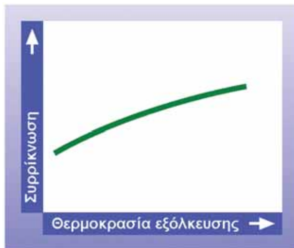
Εικ. 15: Η συρρίκνωση του πλαστικού σε σχέση με τη θερμοκρασία του πλαστικού
