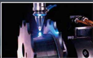
Επιδιόρθωση καλουπιών με συγκόλληση
