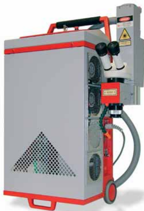
Εικ. 5: Φορητή μηχανή συγκόλλησης με παλμικό λέιζερ
