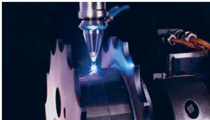
Εικ. 8: Συγκόλληση με παλμικό λέιζερ
