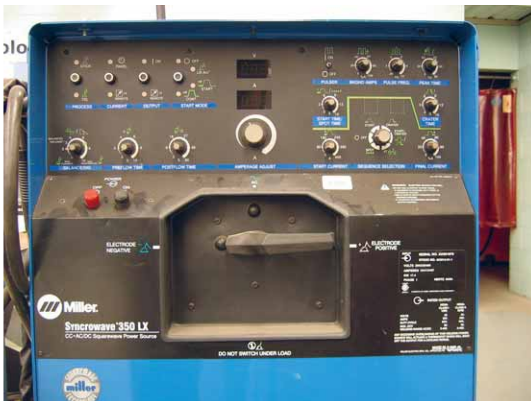
Εικ. 3: Μηχανή παροχής ηλεκτρικού ρεύματος για συγκόλληση TIG
