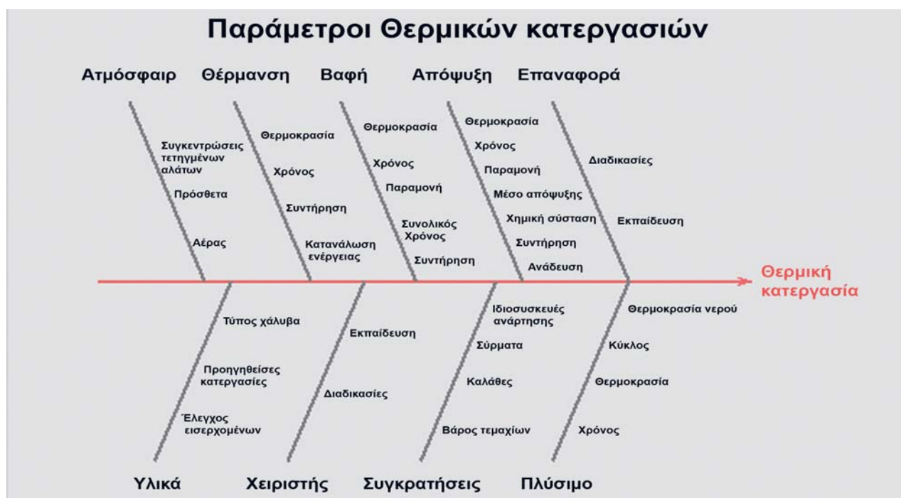
Διάγραμμα 1. Παράγοντες στους οποίους πιθανά να οφείλεται η αστοχία ενός εξαρτήματος κατά τη βαφή του.
