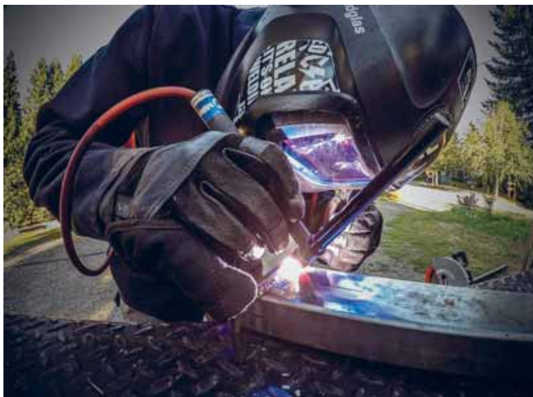
Εικ. 1: Συγκόλληση με αργκόν
