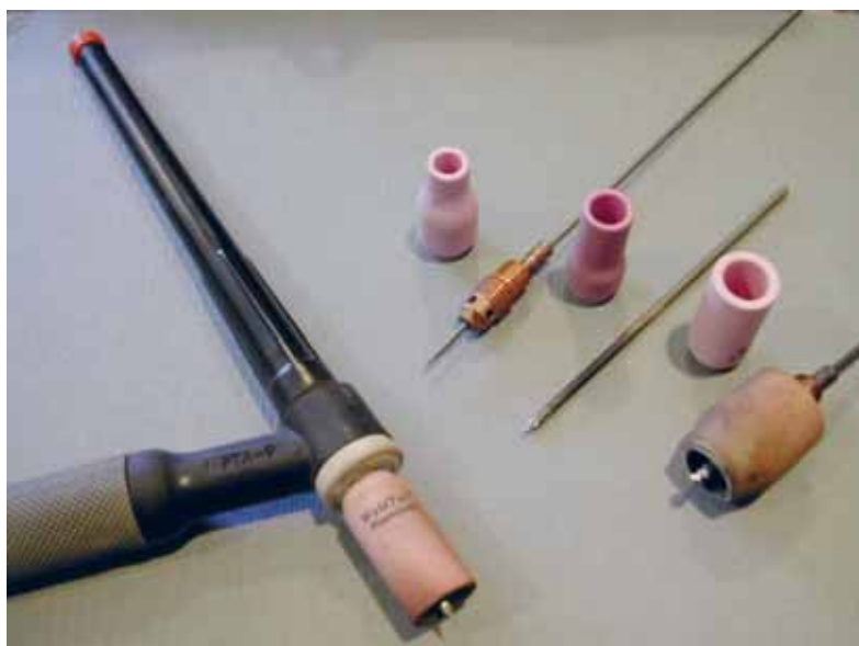
Εικ. 2: Λαβή συγκόλλησης TIG με ακίδα βολφραμίου
