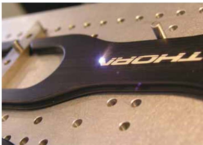
Εικ. 3: Σήμανση προϊόντων με χρήση λέιζερ
