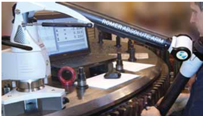
Μέτρηση γραναζιού με φορητή CMM
