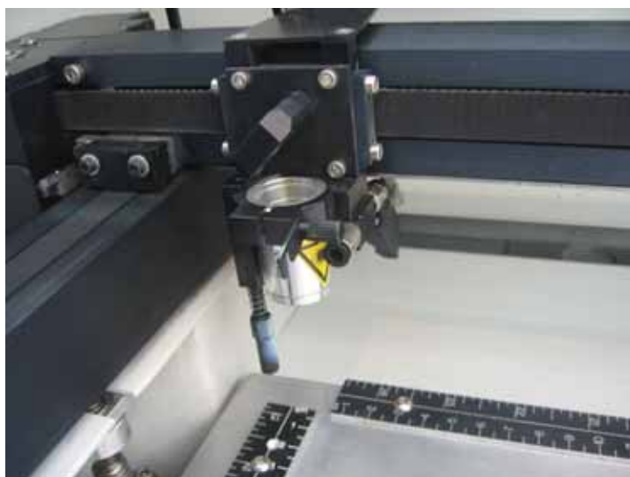
Εικ. 2: Μηχανή χάραξης με λέιζερ με κινητή κεφαλή
