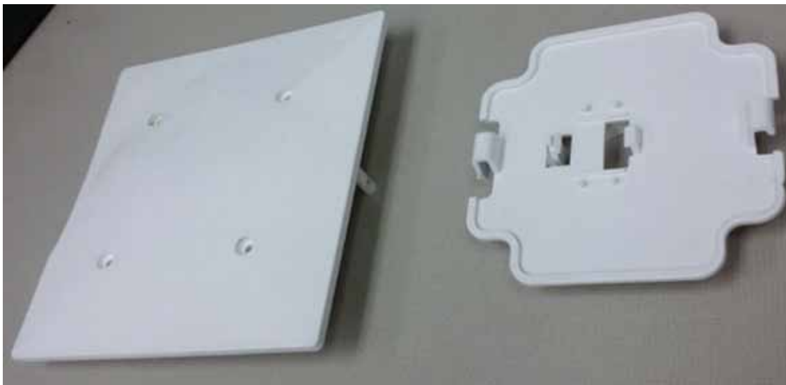
Εικόνα 5. Τα δείγματα που κατασκευάστηκαν για τα δύο εξαρτήματα είχαν ακριβώς τα σημεία ελλιπούς γεμίσματος με αυτά των αποτελεσμάτων της ανάλυσης του Moldex3D
