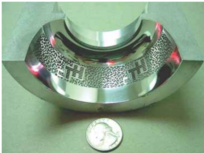
Εικ. 5: Αποτύπωση μορφής σε καλούπι έγχυσης θερμοπλαστικών
