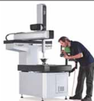
CMM τύπου Πρόβολου. Μοντέλο GLOBAL TIGO. Κατασκευαστής: Hexagon MI
