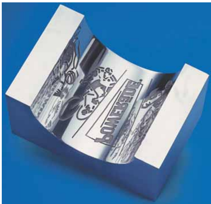
Εικ. 4: Αποτύπωση μορφής σε καλούπι έγχυσης θερμοπλαστικών
