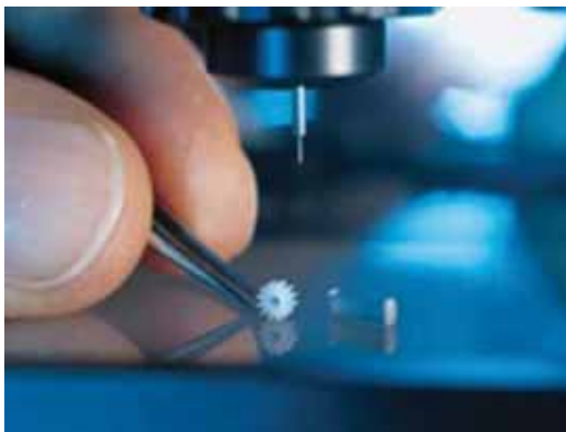
Μέτρηση γραναζιού με σταθερή CMM
