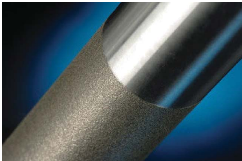
Εικ. 6: Άξονας με επίστρωση EHLA και μερική κατεργασία
