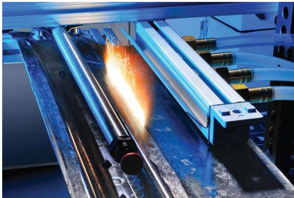
Εικόνα 2 Τελική διαμόρφωση (κοπή) ενός τόξου οροφής υβριδικού αυτοκινήτου από γυαλί και ενισχυμένο πλαστι- κό με ίνες άνθρακα. Fraunhofer ILT, Άαχεν, Γερμανία.
