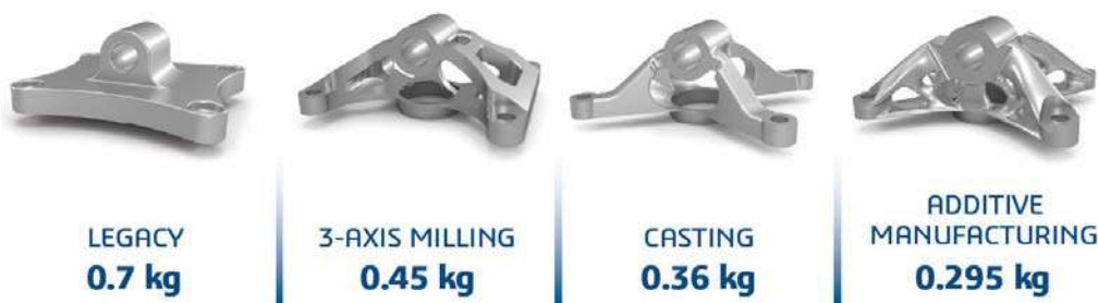
Εικόνα 3. Διαφορετικές μέθοδοι κατασκευής και αποτελέσματα για μείωση του βάρους
