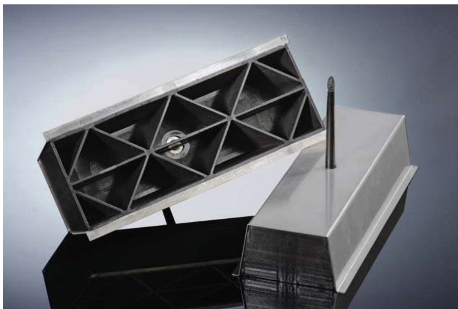
Εικόνα 1 Μικροδόμηση μαγνησίου με λέιζερ και έγχυση στη συνέχεια πλαστικού ενισχυμένου με ίνες γυαλιού (PP-GF30). Fraunhofer ILT, Άαχεν, Γερμανία
