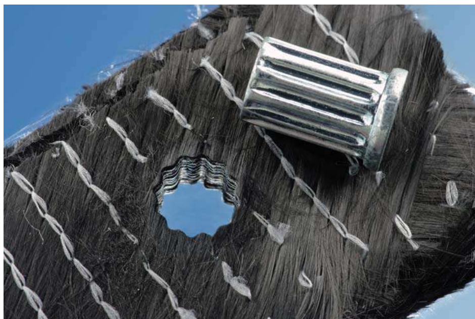
Εικόνα 3 Δέσμη λέιζερ USP τρυπά ίνες άνθρακα και δημιουργεί μια τρύπα σε σχήμα αστεριού για να ταιριάξει ένα μεταλλικό ένθετο. Fraunhofer ILT, Άαχεν, Γερμανία.
