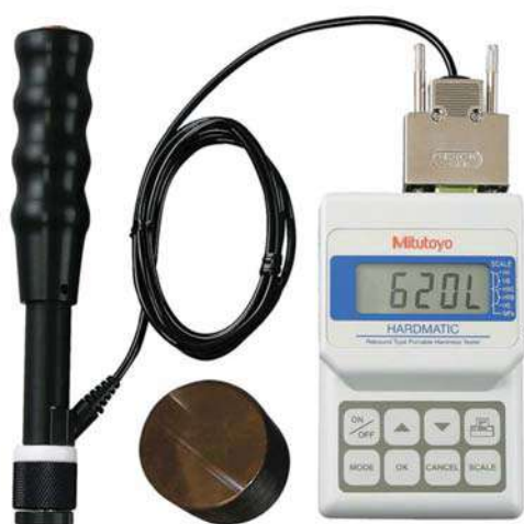
Σχήμα 3. Φορητό σκληρόμετρο που λειτουργεί με τη μέθοδο της αναπήδησης (αριστερά) και με τη μέθοδο της διείσδυσης (δεξιά)
