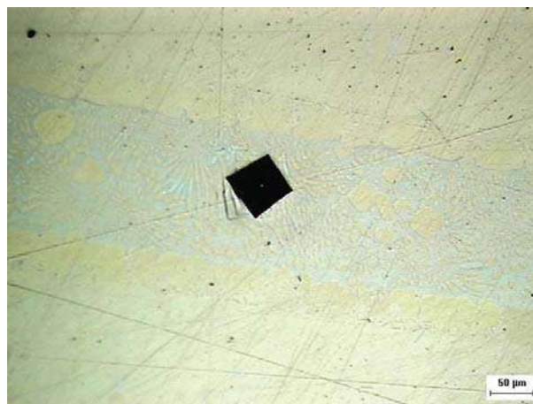
Σχήμα 8. Αποτύπωμα από μικροσκληρομέτρηση Vickers κάτω από το μικροσκόπιο
