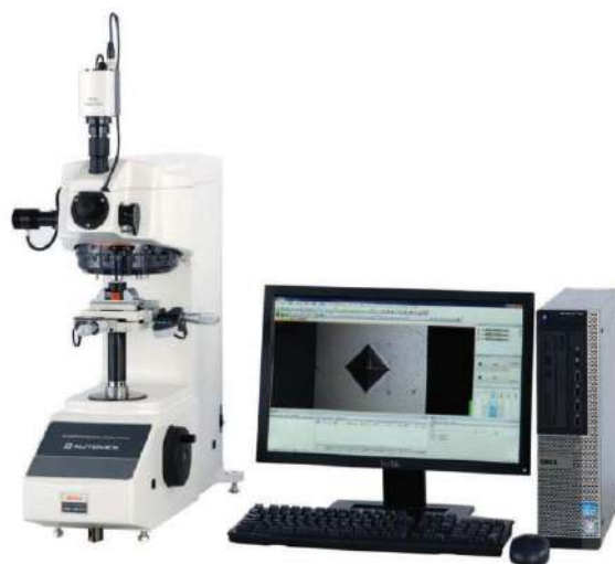
Σχήμα 9. Παρατήρηση και μέτρηση του αποτυπώματος σε σκληρόμετρο Vickers, μέσω κάμερας και ειδικού λογισμικού σε Η/Υ
