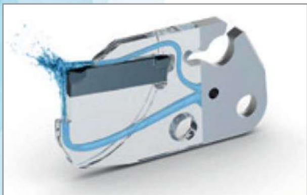
Εικόνα 1. Με το ACS2, ψύχονται ο χώρος κοπής και οι ελεύθερες περιοχές γύρω από αυτόν
