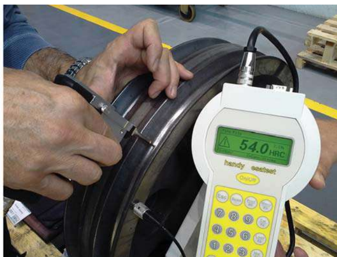
Σχήμα 3. Φορητό σκληρόμετρο που λειτουργεί με τη μέθοδο της αναπήδησης (αριστερά) και με τη μέθοδο της διείσδυσης (δεξιά)
